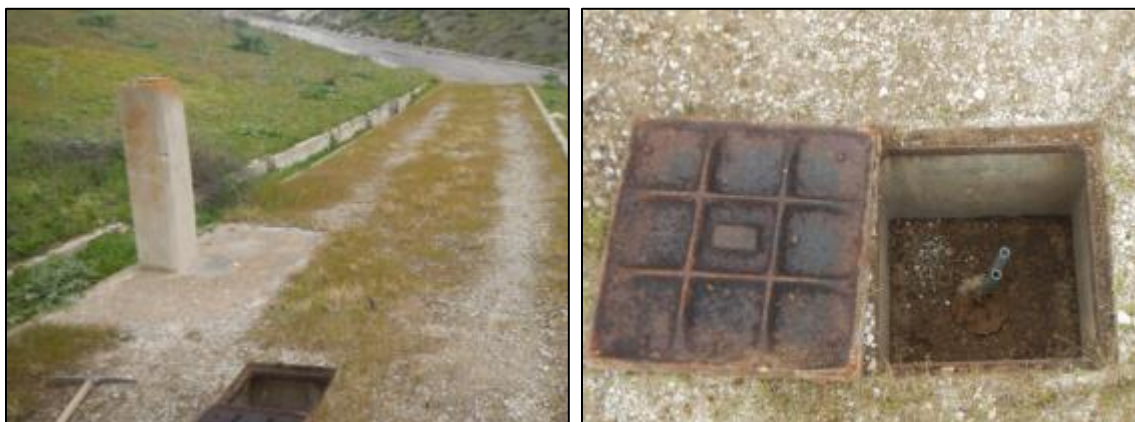
Piezometro Pa2 – Sez. 6 – III berma di valle
